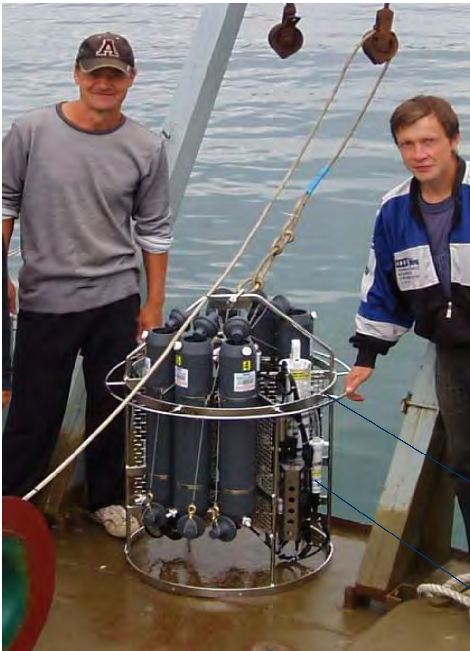
Кассета батометров SBE 55 ECO (4 л, 6 шт.)
